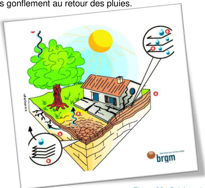
Figure 36 : Schéma du phénomène de retrait-gonflement des argiles. (Source BRGM)
